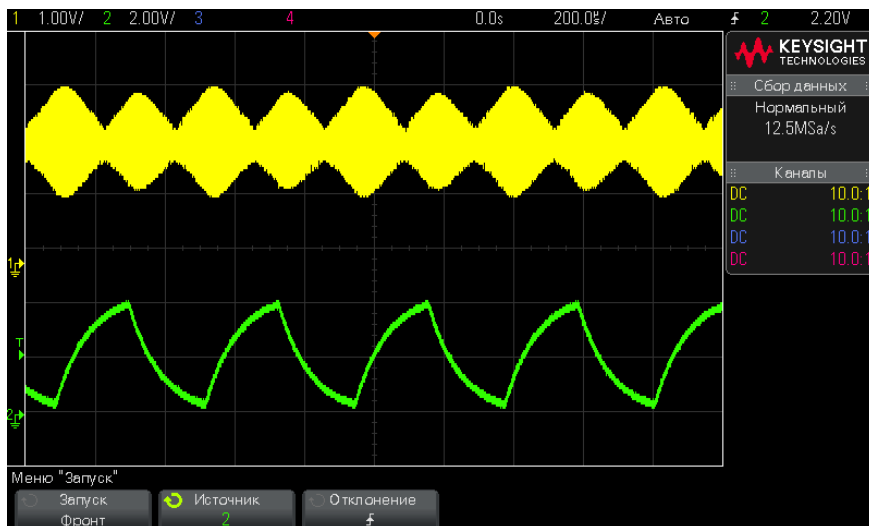
Рис. 25 Отображение амплитудной модуляции при яркости 100%
